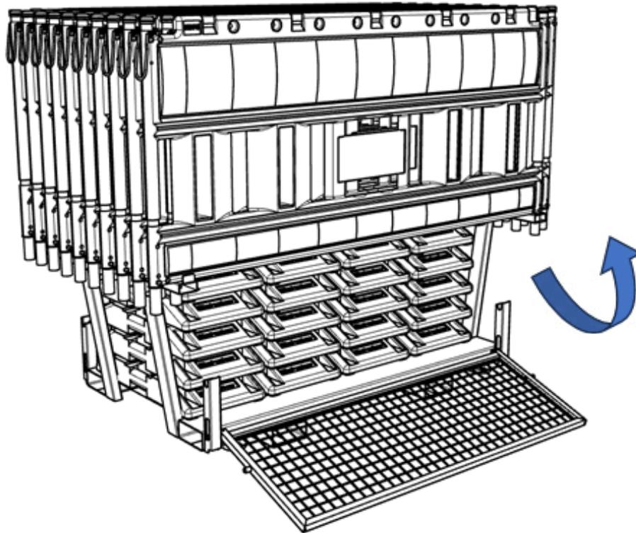
3. Absperrschrankengitter einseitig in die Löcher am Rechteckrohr einstecken.
