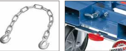
Sicherungskette Gliederkette als Abrutschsicherung mit Abschlepphaken.
